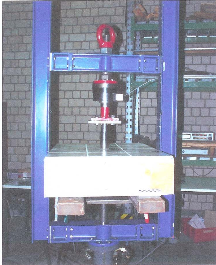
Bild 1: Dynamisches Prüfsystem mit Probekörper
