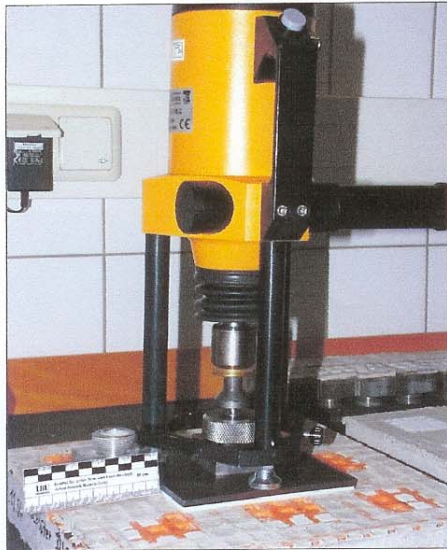
Bild 1 und 2: Ermittlung der Haftzugfestigkeit mit dem Prüfgerät F6 D Easy MLC
