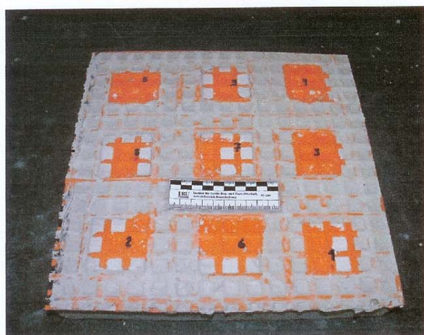
Bild 5: Bruchbilder des Prüfkörpers mit der Spezialverlegematte Schlüter-DITRA
