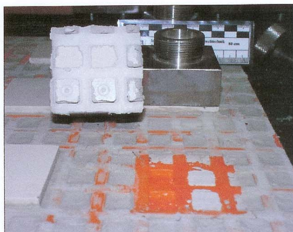
Bild 6: Bruchbild des Prüfkörpers mit der Spezialverlegematte Schlüter-DITRA (Detail)
