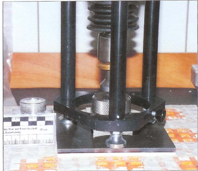
Bild 1 und 2: Ermittlung der Haftzugfestigkeit mit dem Prüfgerät F6 D Easy MLC
