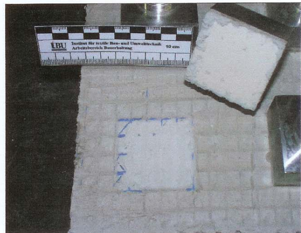
Bild 4: Bruchbild des Prüfkörpers mit der Spezialverlegematte Blanke • PERMAT (Detail)
